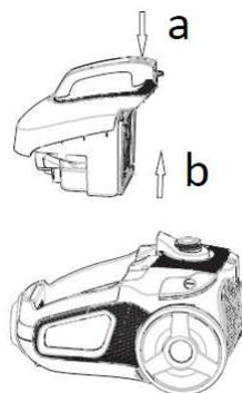
2. Tire del pestillo hacia arriba para abrir la tapa del depósito de polvo. Retire el filtro y vacíe el contenido.
