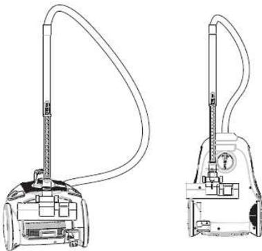
Cuando haya terminado de aspirar, puede guardar el tubo insertándolo en el sujetador de la parte posterior de la aspiradora.
