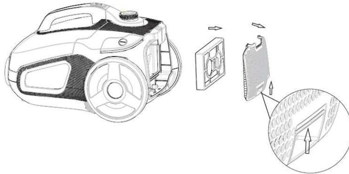
1. Empuje el pestillo de la rejilla de salida de aire hacia arriba. Retire el filtro, limpie la parrilla y el filtro con agua y deje que se sequen completamente antes de volver a colocarlos en el aparato.
