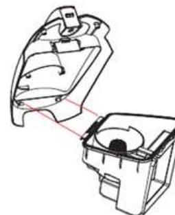
6. Vuelva a colocar el depósito en el aparato.
